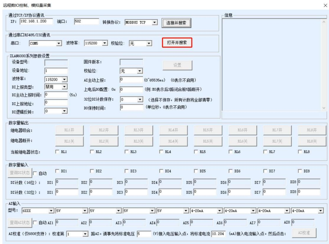
连接后可以更改设置 modbus 从站站号以及串口波特率等串口参数，其他 AI、DI、DO 参数可以根据客户需要设置。
