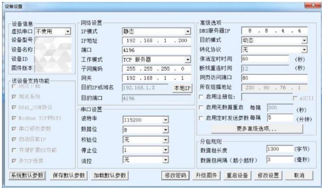
转换协议可以根据需要选择，无表示 modbus rtu，也可以选 modbus tcp 协议。
