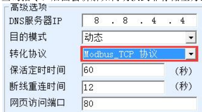
图 16 启用 Modbus TCP 功能
