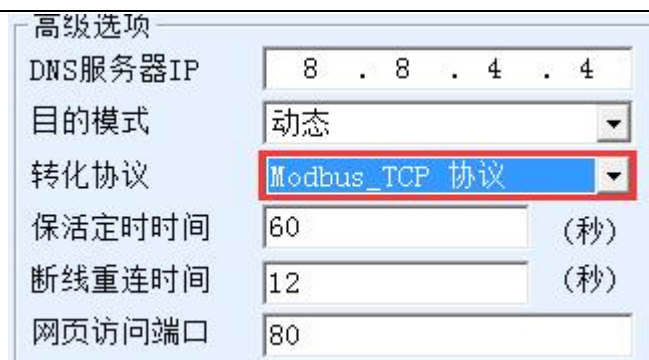
图 9 启用 Modbus TCP 功能
