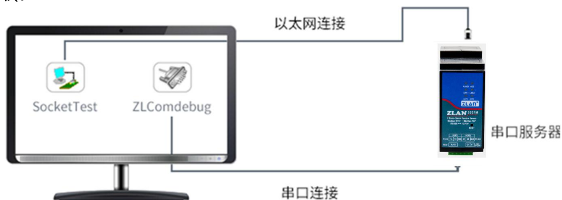
图 9 TCP 通讯示意图
