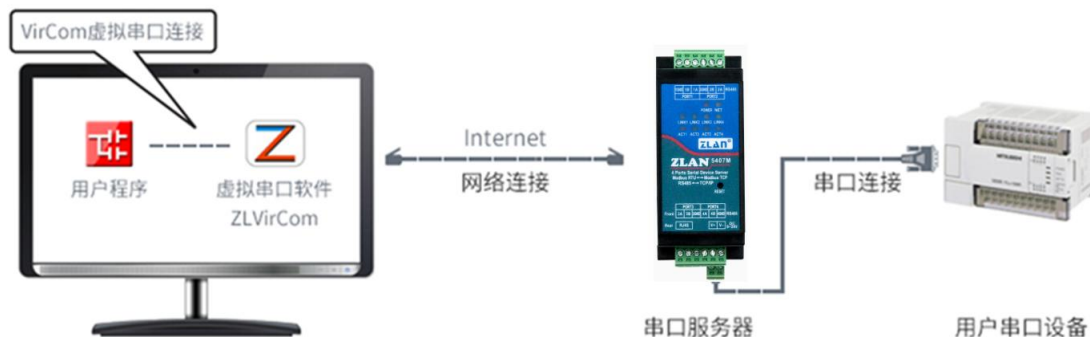
图 12 虚拟串口的作用
