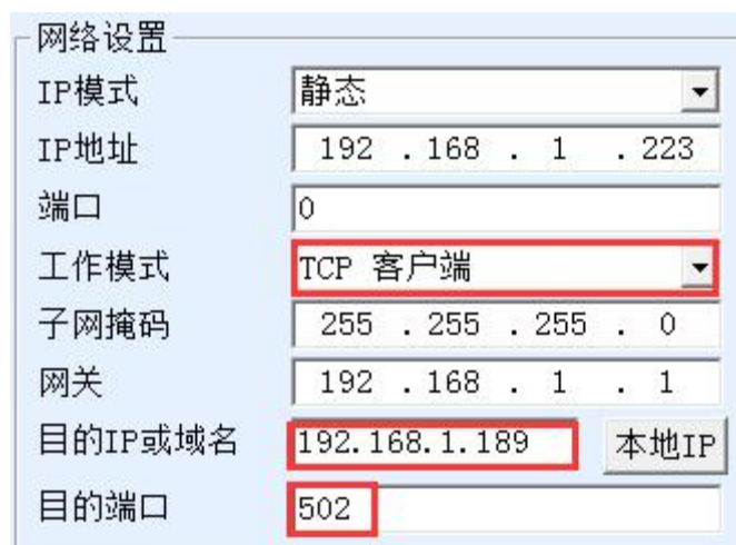
图 15 Modbus TCP 做客户端。
