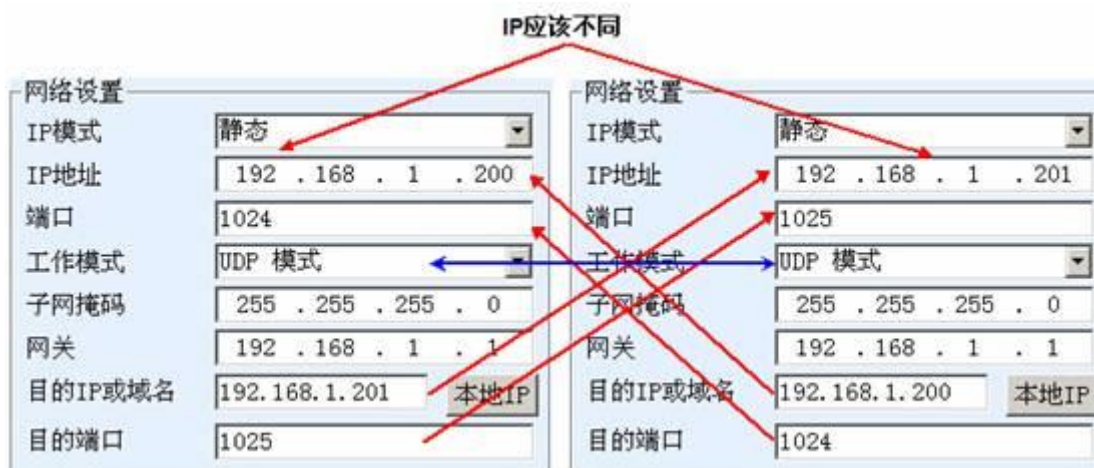
图 21 UDP 设备对联参数配置
