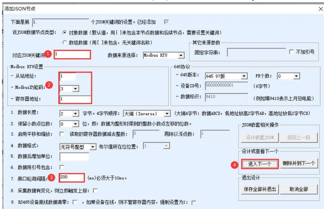
图 43 配置采集的关键词，寄存器地址以及采集间隔
