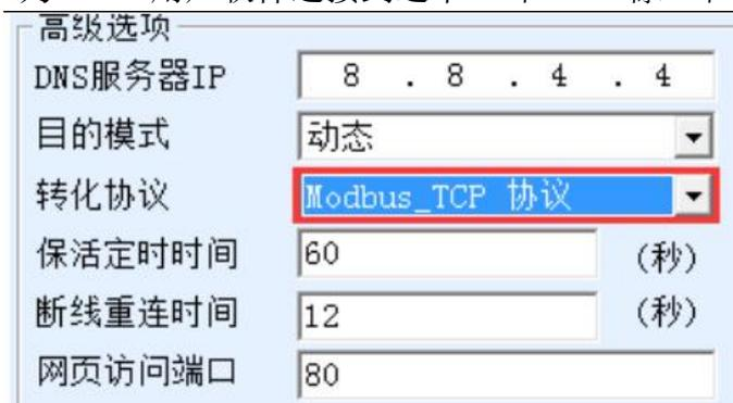
图 50 启用 MODBUS TCP 功能
