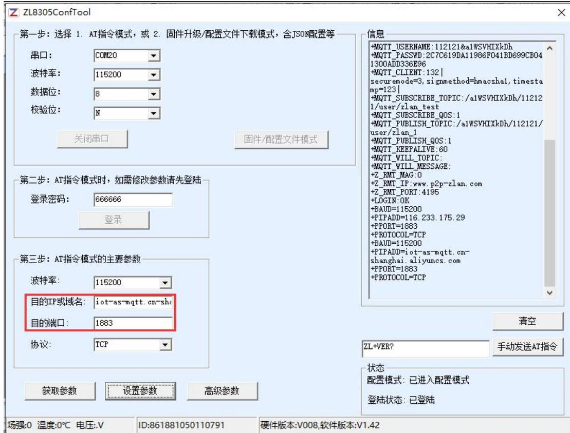
图 37 阿里云 IP 和端口
