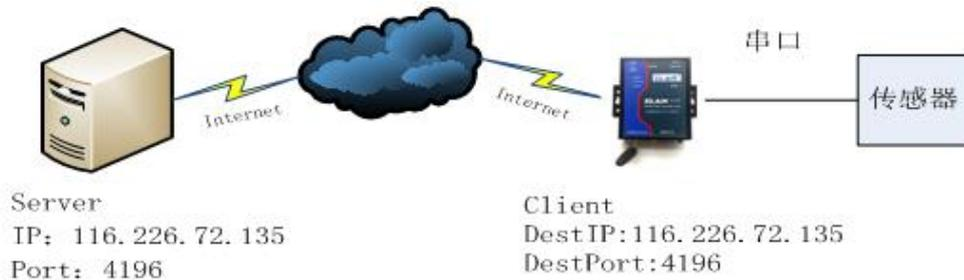
图 32 联网结构图
