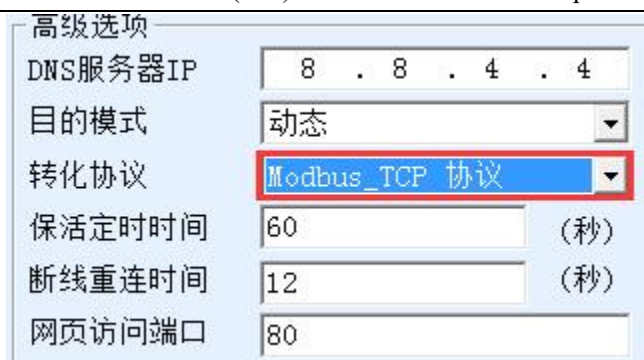
图 24 启用 Modbus TCP 功能
