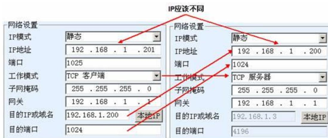
图 31 TCP 设备对联参数配置
