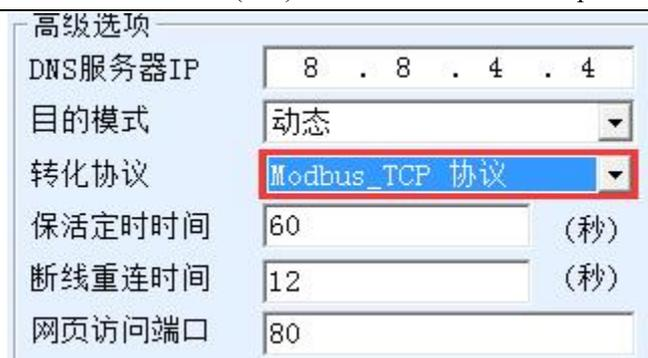
图 21 启用 Modbus TCP 功能
