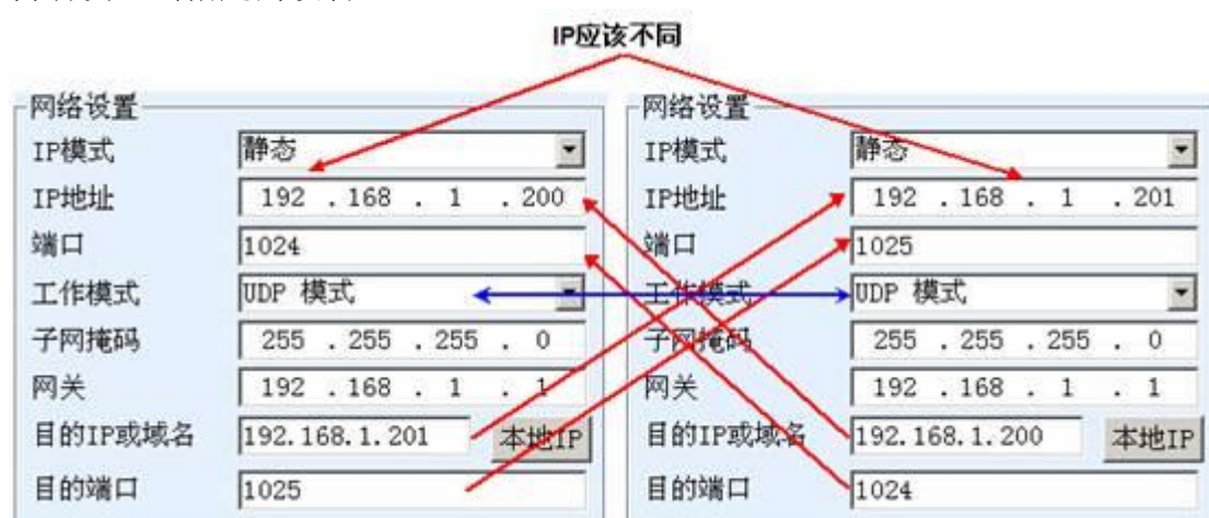
图 29 UDP 设备对联参数配置
