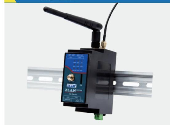
ZLAN9809M-4G是一款高性价比的工业4G路由器，具备4个LAN口、一个WAN接口和WIFI接口。4个LAN口组成内网，可以选择WAN、4G或WIFI上网。4个LAN口具有交换机功能。采用导轨安装，端子式供电，9~24V宽电压输入。具有工业级温度，通过4级抗静电干扰。
