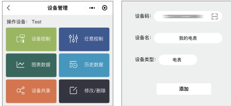
添加完设备后，添加所需的JSON关键词（如“power”），同时在卓岚网关（如ZLAN8305）配置时将“power”和网关连接的Modbus站地址、寄存器对应起来。之后ZLAN8305会自动采集数据，并将数据上发，如下图所示。
