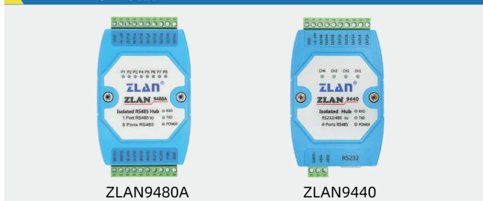
RS485集线器可以在多个RS485互相连接时，起到隔离、中继、扩展的作用。485集线器又分为4口集线器和8口集线器，分别对应为ZLAN9440和ZLAN9480A。ZLAN9440的主口可以为RS232或者RS485，而ZLAN9480A主口只能为RS485。
