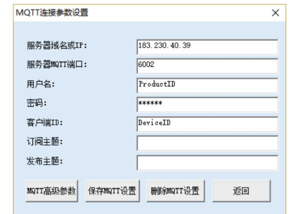
配置 MQTT 参数时，点击设备参数对话框的“固件与配置”，然后点击“MQTT 配置”输入主题等参数，下载配置即可使用
