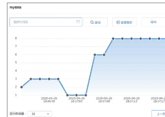
在MQTT配置时，将OneNet平台注册时所添加的设备的信息和网关的MQTT配置信息对应起来，如上图所示。之后在OneNet平台上可以看到mydata这个数据节点，点击可以看到ZLAN5144j网关所采集的mydata的数据。
