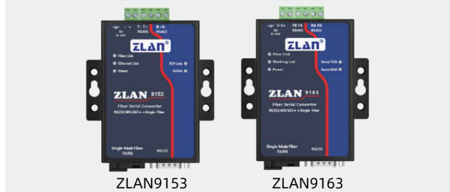
ZLAN9153和ZLAN9163两款产品都可以将RS232/RS485/RS422转换为光纤信号。ZLAN9153采用在光纤上走TCP/IP协议的方式传输，实际是ZLAN5103+ZLAN9100的方式，可以通过光纤交换机通讯，但是必须配置设备波特率。ZLAN9163则可以成对使用，通过光纤实现串口转串口的远程传输，即插即用无需配置波特率。长×宽×高=9.4cm×6.5cm×2.5cm。
