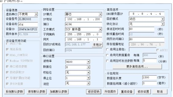
串口参数和 zigbee 参数保持一致,网络参数按照上图配置。
