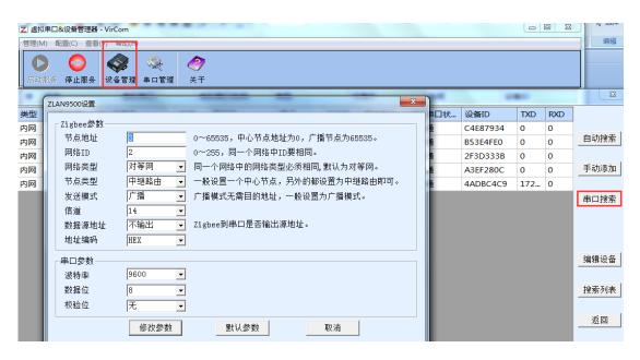
按照上图配置,一个网络中网络 ID 必须相同,波特率必须和 9600 接的串口设备波特率一致。另一个只需要将节点地址改一下可以,其他参数不变。
